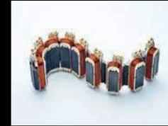
Mitsubishi Electric ha creato e sviluppato un motore elettrico DC Inverter estremamente compatto ed altamente efficiente denominato "Poki Poki". Lo statore del motore Poki Poki non è costituito da un corpo unico ma sezionato in più parti (noccioli). I singoli noccioli subiscono singolarmente il processo di avvolgimento della bobina (Joint Lap), in modo tale che il processo di avvolgimento minimizzi lo spazio morto ed aumenti l'efficienza.
