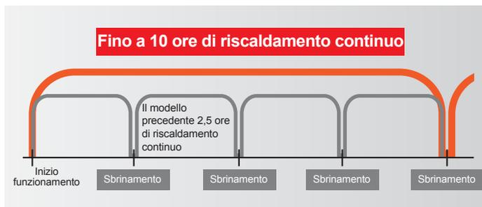
Comparazione fra PUHZ-SHW AA e la nuova PUD-SHWM. Prove effettuate nei laboratori alle condizioni di temperatura a -15°C e massima frequenza. Il tempo effettivo potrebbe variare in condizioni reali.
