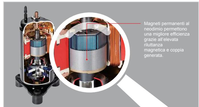
I compressori rotativi Mitsubishi Electric fanno uso del motore brevettato "Poki-Poki". Questa tecnologia permette di realizzare avvolgimenti ad alta densità e quindi ottenere un campo magnetico più intenso in grado di **aumentare l'efficienza del componente**.
