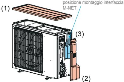
Bisogna solo rimuovere il (1) pannello superiore, (2) pannello di servizio e (3) la lastra di servizio. Il box elettrico, il pannello frontale non vanno rimossi e non c'è bisogno di disconnettere il connettore.
